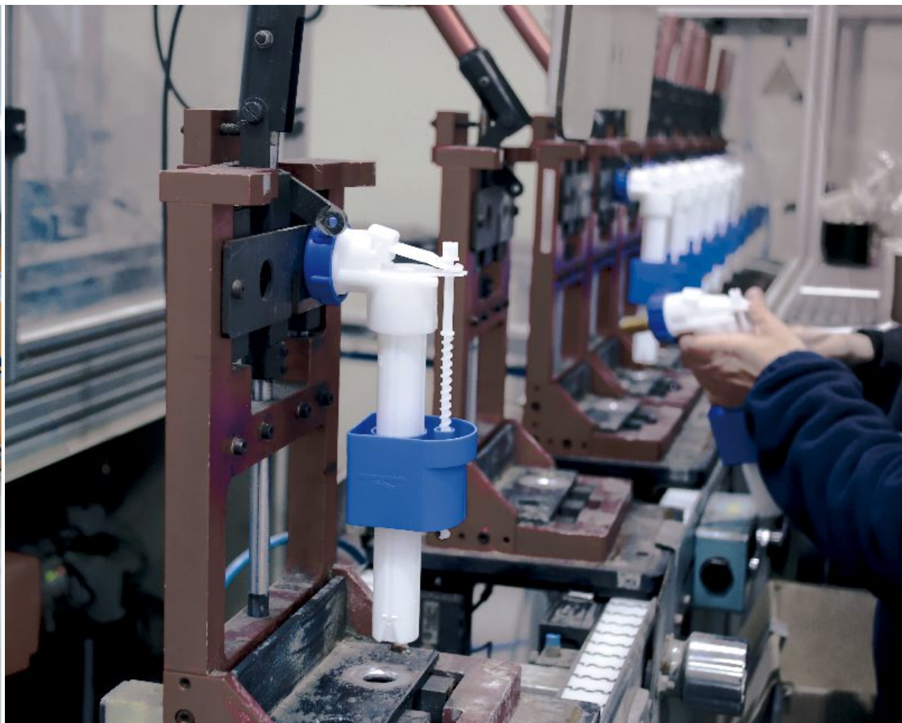
ESTACIÓN DE COMPROBADO GRIFOS SERVO
