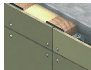
Fibrocemento sobre madera.
