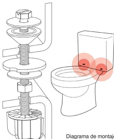
Diagrama de montaje Tornillos
