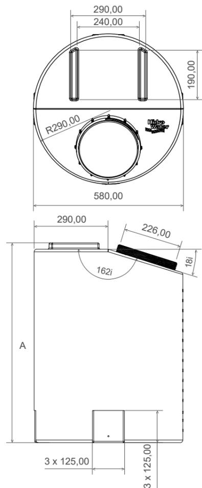
Montaje dosificadora y montaje agitador
