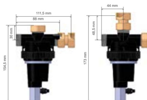
Filtro ultracompacto que elimina los lodos, residuos ferrosos o arenosos que circulan por las tuberías de los sistemas de calefacción. Gracias a su potente imán, el filtro puede eliminar las partículas ferrosas del agua y cualquier otra impureza a través de una malla filtrante de acero inoxidable de 500 micras.
