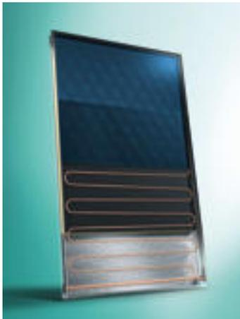
El captador VFK 135 VD está especialmente diseñado para funcionamiento en instalaciones de drenaje automático. Este sistema, al ser capaz de vaciar los captadores y la tubería de conexión por completo, elimina el riesgo de congelaciones en invierno y sobretemperaturas en verano.
