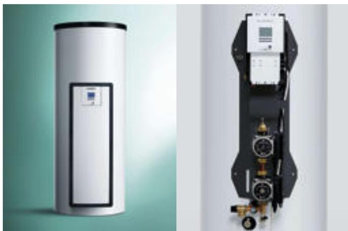
Producción solar de ACS tipo drenaje automático de carácter modular que permite al sistema ganar en flexibilidad. El depósito solar se puede combinar con un módulo solar que incluye todos los elementos necesarios: control, bomba y tuberías. Como accesorio está disponible la bomba auxiliar para llegar hasta 12 m de altura o la resistencia eléctrica de apoyo.
