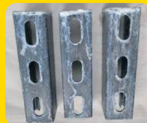
Probetas a 1.000 horas en NSS
