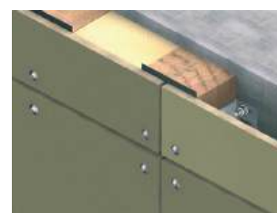
Fibrocemento sobre madera.
