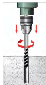
Taladrar con broca de 8 [mm]
