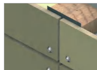
Fibrocemento sobre madera
