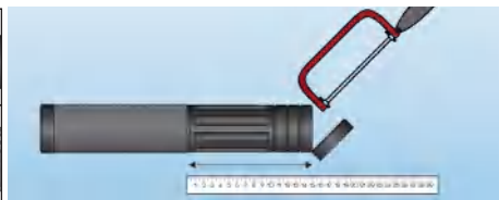
2. Medir el espesor del aislamiento y cortar ResiTHERM® si es necesario (máx. 40 mm).
