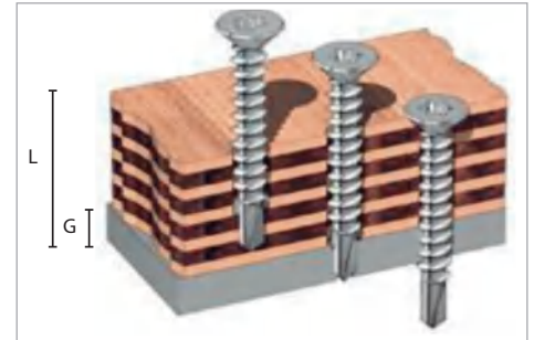
G: Espesor del perfil metálico.C
