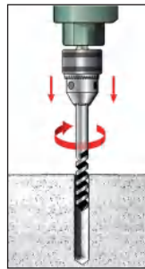
Taladrar con broca de 8 [mm]
