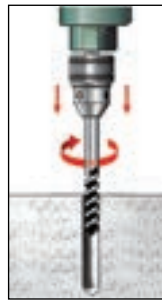
Taladrar con broca de 8 [mm]
