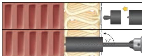
1. Coloque la guía en la broca de un destornillador (sin impacto) a través del material aislante a la pared de ladrillo hueco (quitar la guía de la perforación después de los primeros 10 milímetros).
