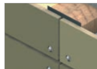
Fibrocemento sobre madera
