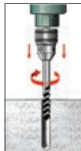
Taladrar con broca de 8 [mm]
