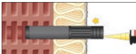
5. Introducir el ResiTHERM® cuidadosamente en el agujero con la boquilla de la mezcla.
