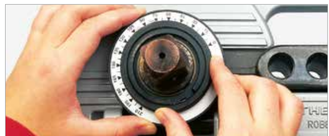
Ajuste previo del ángulo de la curva sin herramientas
