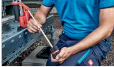
2. Escariar la parte externa del tubo
