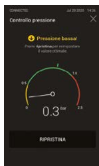
Restablecimiento de presión sistema semiautomático
